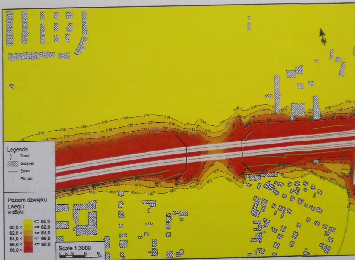
Rys. 1 Model terenu w rejonie tunelu przyjęty do obliczeń akustycznych (kolorami zaznaczono warstwy, interpretacja rysunku wg wersji elektronicznej)
