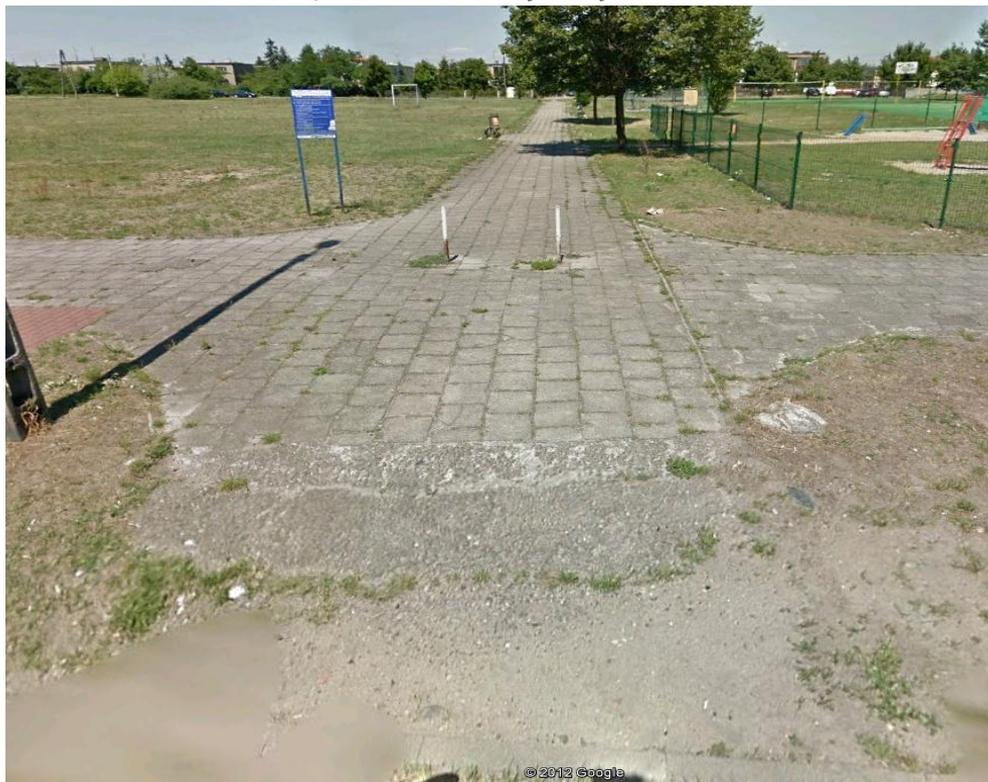
Przeście znajduje się w złym stanie technicznym – płyty chodnikowe są połamane, kosze i ławki częściowo uszkodzone. Zadanie obejmuje remont nawierzchni alejki, montaż nowych ławek i koszy na śmieci oraz montaż oświetlenia zasilanego energią z paneli solarnych.
